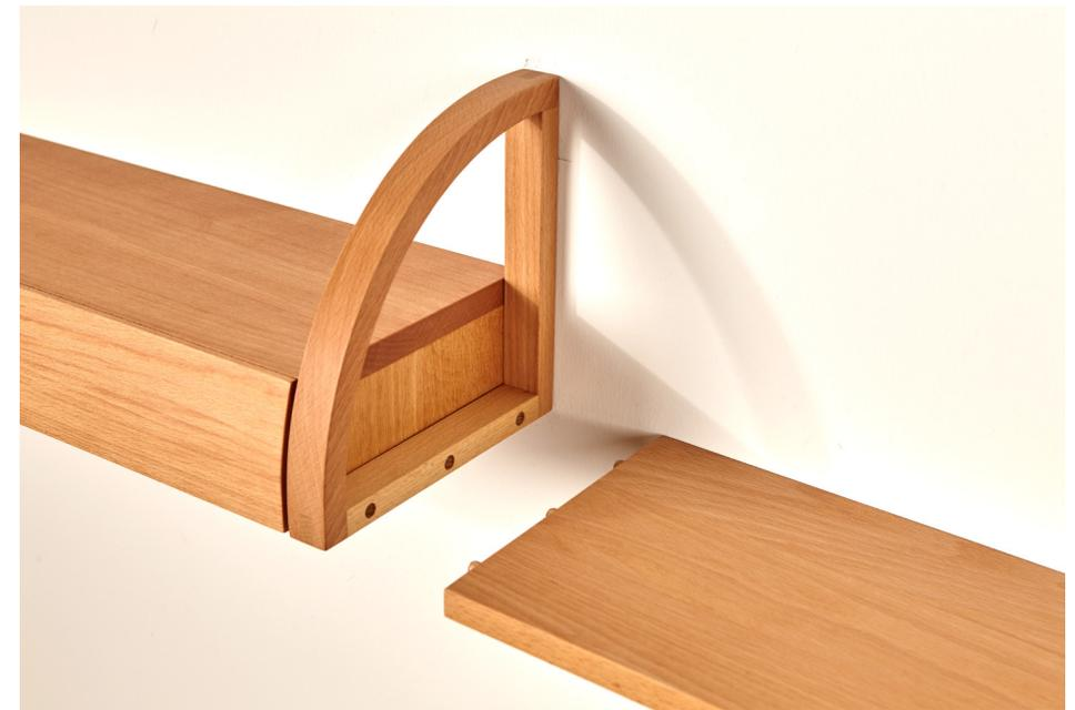
**6.** Weiterbauen des Regals: nächsten Teil (Fachbrett bzw. Ladenteil) in den Mittelbügel stecken, Seitenbügel als Abschluss an den angebauten Teil stecken. Anbau waagrecht positionieren, Bohrstellen an der Wand markieren (jeweils nur für die obere Wandhalterung der Bügel), bohren, dübeln, Schrauben eindrehen. Anbau in die Schrauben einhängen.
