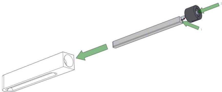
**5.** ... bis das Ende der LED bündig mit der Ausfräsung in der LED-Halterung ist.
