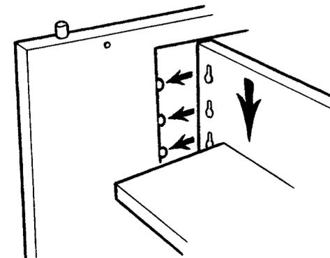
**2.** Hängen Sie die Blende so in die Seitenteile ein, dass die Ausnehmungen auf beiden Seiten die Schwalbenschwänze der Seitenteile aufnehmen. Klopfen Sie die Blende rechts und links gleichmäßig nach unten fest.
