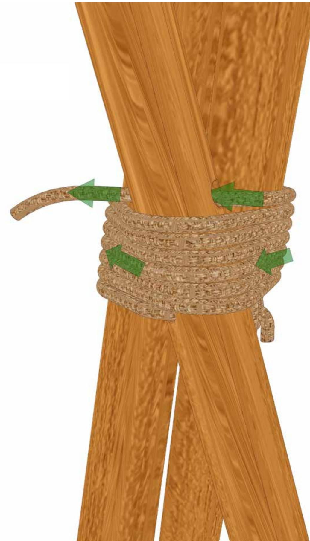
**8.1.** Seil mit einer Hand kräftig anziehen. **8.2.** Keil mit der anderen Hand in die Bohrung stecken und fest andrücken, um das Seil gut einzuklemmen (**8.3.**).
