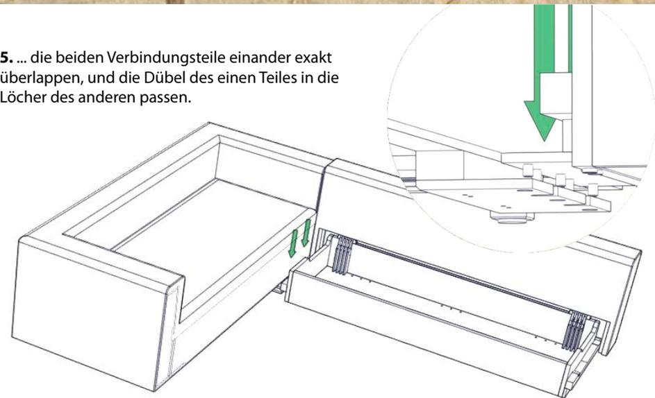
**6.** Den Anbauteil vorsichtig wieder auf den Boden setzen. Die beiden Verbindungsteile müssen satt und bündig ineinandergreifen.
