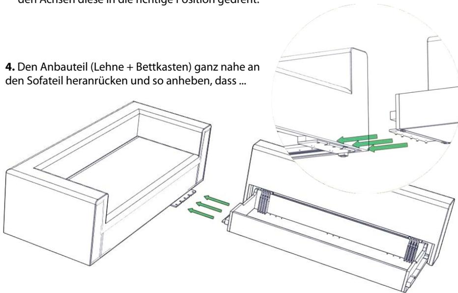
**5.** ... die beiden Verbindungsteile einander exakt überlappen, und die Dübel des einen Teiles in die Löcher des anderen passen.
