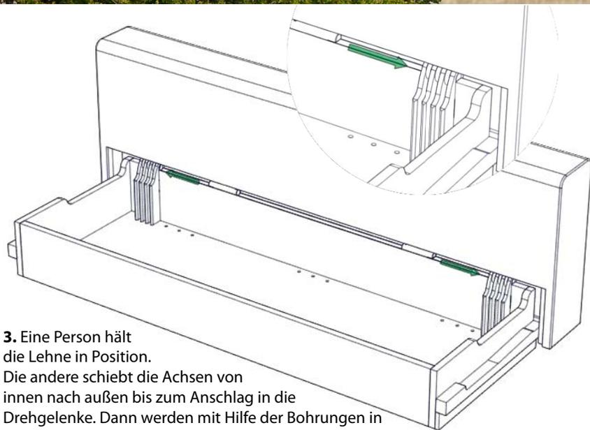
**3.** Eine Person hält die Lehne in Position. Die andere schiebt die Achsen von innen nach außen bis zum Anschlag in die Drehgelenke. Dann werden mit Hilfe der Bohrungen in den Achsen diese in die richtige Position gedreht.
