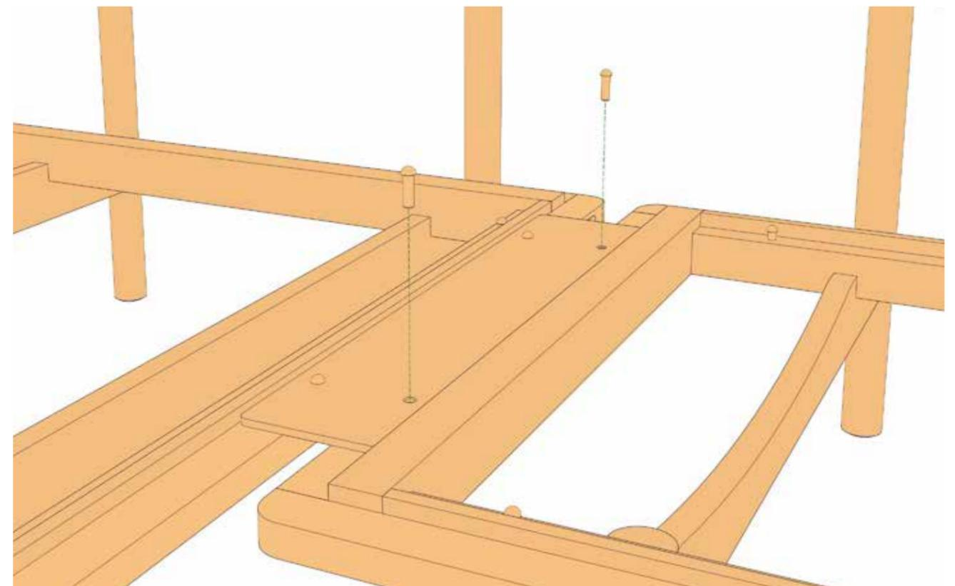
**4.** Federleisten an der Unterseite des Sitzpolsters zurechtrücken: Das lockere Federleistenband (mit dem Knopfloch) in Richtung des gegenüberliegenden festen Leistenbandes ziehen, sodass die Leisten tief in dessen Fächer hineingedrückt werden. Die Federleisten sollen parallel und in einer Linie liegen.
