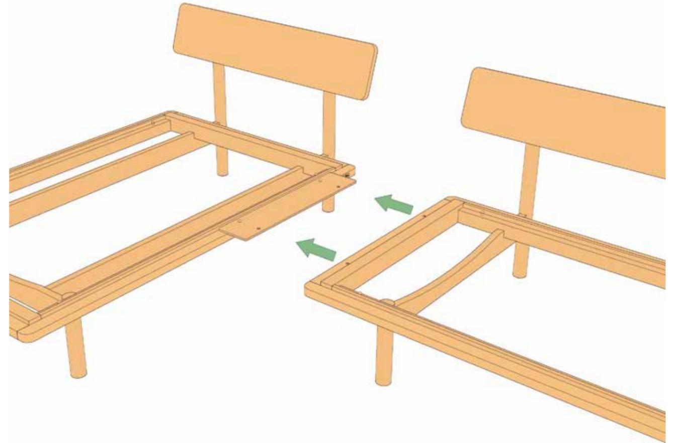
3. Holzdübel bis zum Anschlag in die Bohrungen drücken/klopfen.
