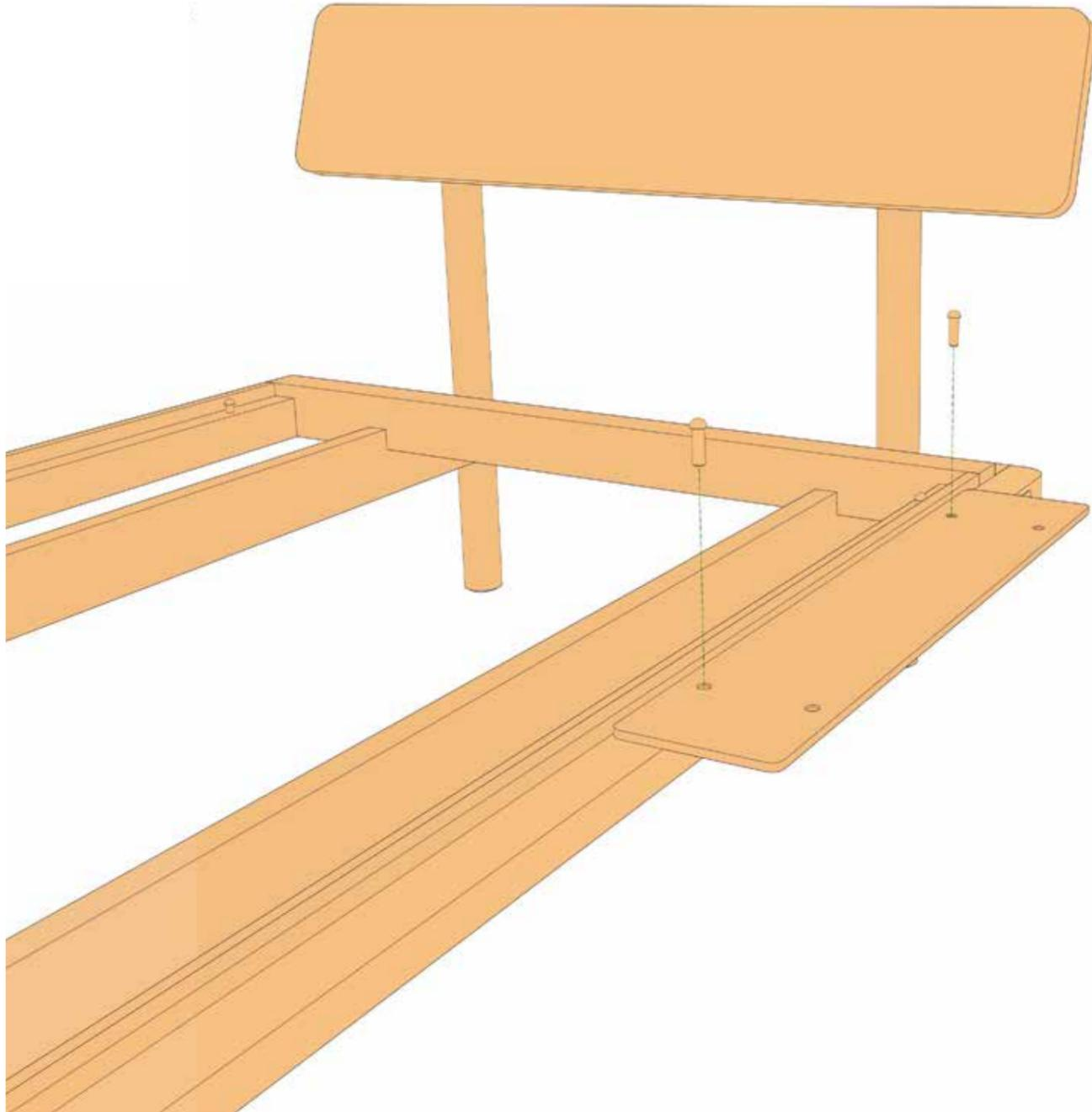
2. Sitzteil an den Liegeteil heranrücken und so positionieren, dass die Bohrungen im Rahmen des Sitzteils exakt unter den Löchern der Verbindungsplatte liegen.
