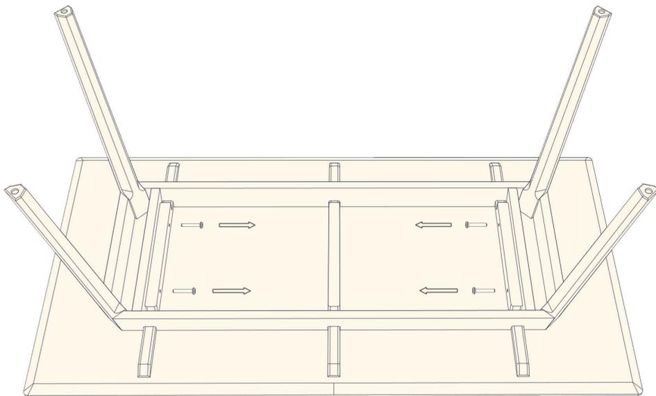
Zum Zerlegen des Tisches Dübel herausziehen, falls nötig mit Hilfe einer Kombizange.
