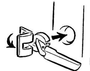
6. Die Türen werden „eingehängt“, indem Scharniere und Grundplatten *von oben nach unten* nacheinander zusammengedrückt werden.
