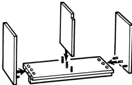
3. Lassen Sie die Rückwände von oben in die Führungsnuten gleiten. Stecken Sie oben die Deckplatte auf und ziehen Sie innen die Verbinder zwischen Wänden und Deckplatte fest.
