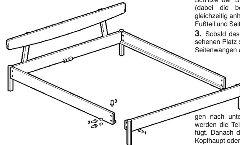
2. Fußteil mit den Laschen in die Schlitzte der Seitenwangen stecken (dabei die beiden Seitenwangen gleichzeitig anheben). Mit den Stiften Fußteil und Seitenwangen verbinden.
