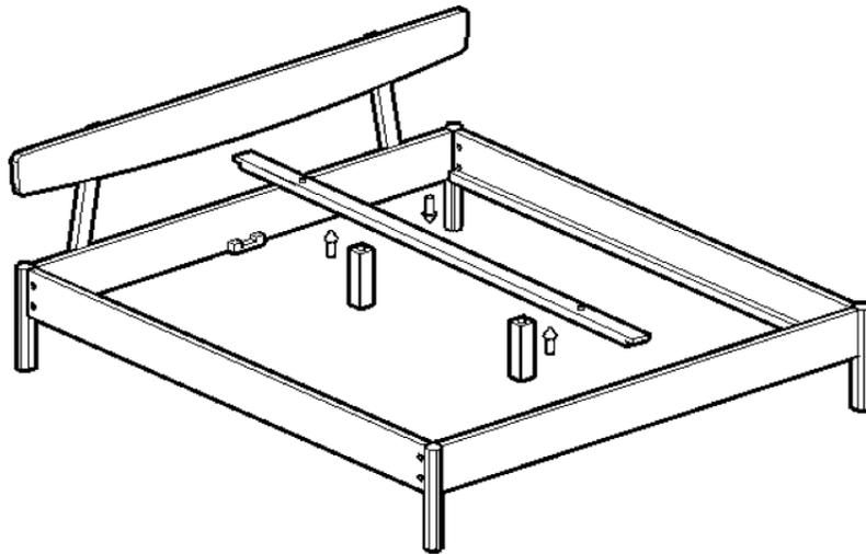
**4.** Bei Bettbreiten ab 160 cm: beide Mittelfüße aufstellen, Mittelsteg in den Bettrahmen einlegen und gleichzeitig mit den Mittelfüßen verbinden. Dann können Lattenrost(e) und Matratze(n) aufgelegt werden.
