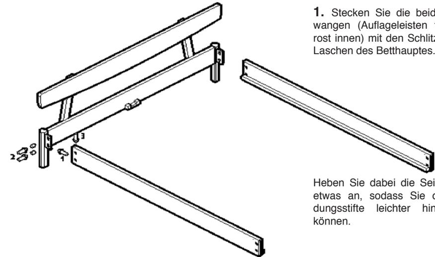
1. Stecken Sie die beiden Seitenwangen (Auflageleisten für Lattenrost innen) mit den Schlitzten auf die Laschen des Betthauptes.
