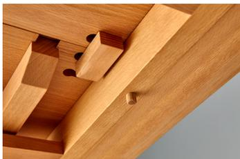
**6.** Plattenverbinder mit Gratsdübeln in die schlüssellochartige Ausnehmung stecken und festklemmen. Dann links und rechts die beiden Sicherungsstifte hineindrücken – diese verhindern, dass die beiden Tischhälften zu weit auseinander gezogen werden.
