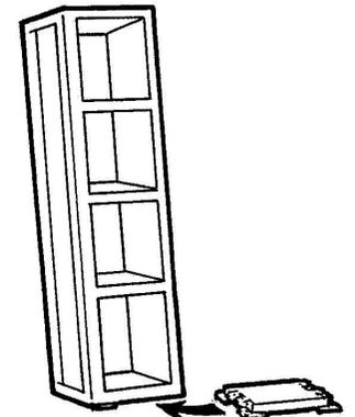
2. Je nach Breite Ihres Regals ist das nächste Element entweder Ihr zweites Grundelement (als Abschluss) oder ein Verbindungselement: Dieses Element verbinden Sie wie abgebildet mit der Bodenplatte. (Beim Verbindungselement ist oben dort, wo sich seitliche Bohrungen in der Deckplatte befinden!)
