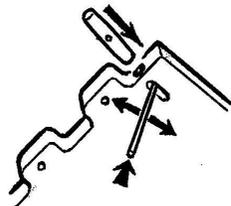
4. Stecken Sie die 4 Verbindungsstifte in jede Deckplatte und legen Sie die Deckplatte(n) oben auf. Mit dem Metallstift schieben Sie die Verbindungsstifte zum Sichern der Deckplatte(n) nach außen. Zweites Abschlusselement wie zuvor anfügen.
