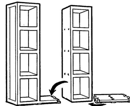
3. Bei Bodenplatten über 2 oder 3 Elementbreiten folgt nun der Einbau der Trennwand bzw. zweier Trennwände. Wo oben und unten bei den Trennwänden ist, erkennen Sie beim Einstellen daran, dass die Bohrungen für die Fachbretter auf gleicher Höhe mit den anderen Wänden sein müssen. Stecken Sie die Trennwände ein und legen Sie sofort einen Fachboden rechts und links der Trennwand auf die Bodenplatte, damit die Trennwand nicht kippt.
