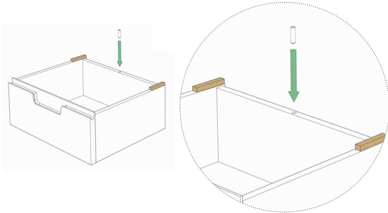
**6. Lade einige Zentimeter ins Fach schieben, Ladenstopper in die Bohrung an der Unterseite des Fachbrettes stecken und durch Verschieben nach links fixieren.**
