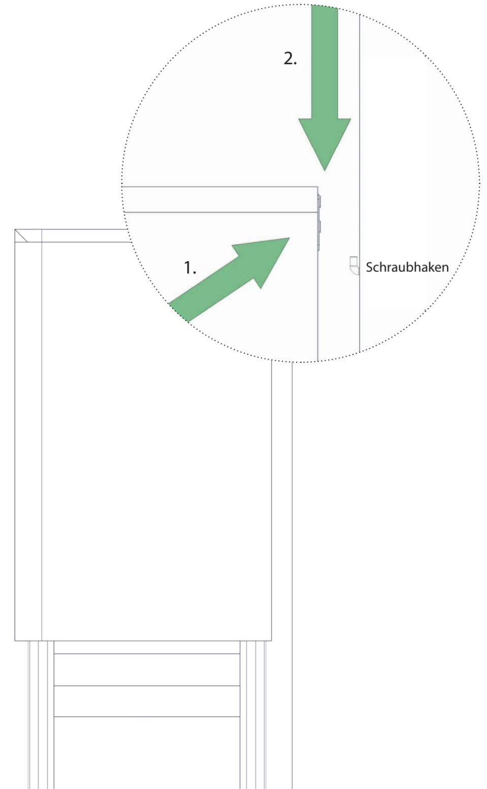
**5. Laden montieren:** Holzdübel in die Bohrung oben in der Rückwand stecken.
