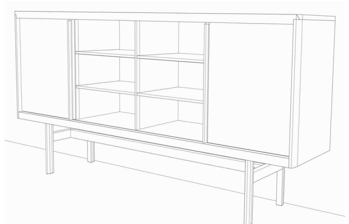
**9. Schiebetür ausbauen:** Tür anheben, unten aus der Laufrille schwenken und nach vorne herausheben. Zum Einbau der Tür in umgekehrter Reihenfolge vorgehen: Zuerst in die obere Laufrille einfädeln, dann in den Korpus schwenken und in die untere Laufrille absenken.
