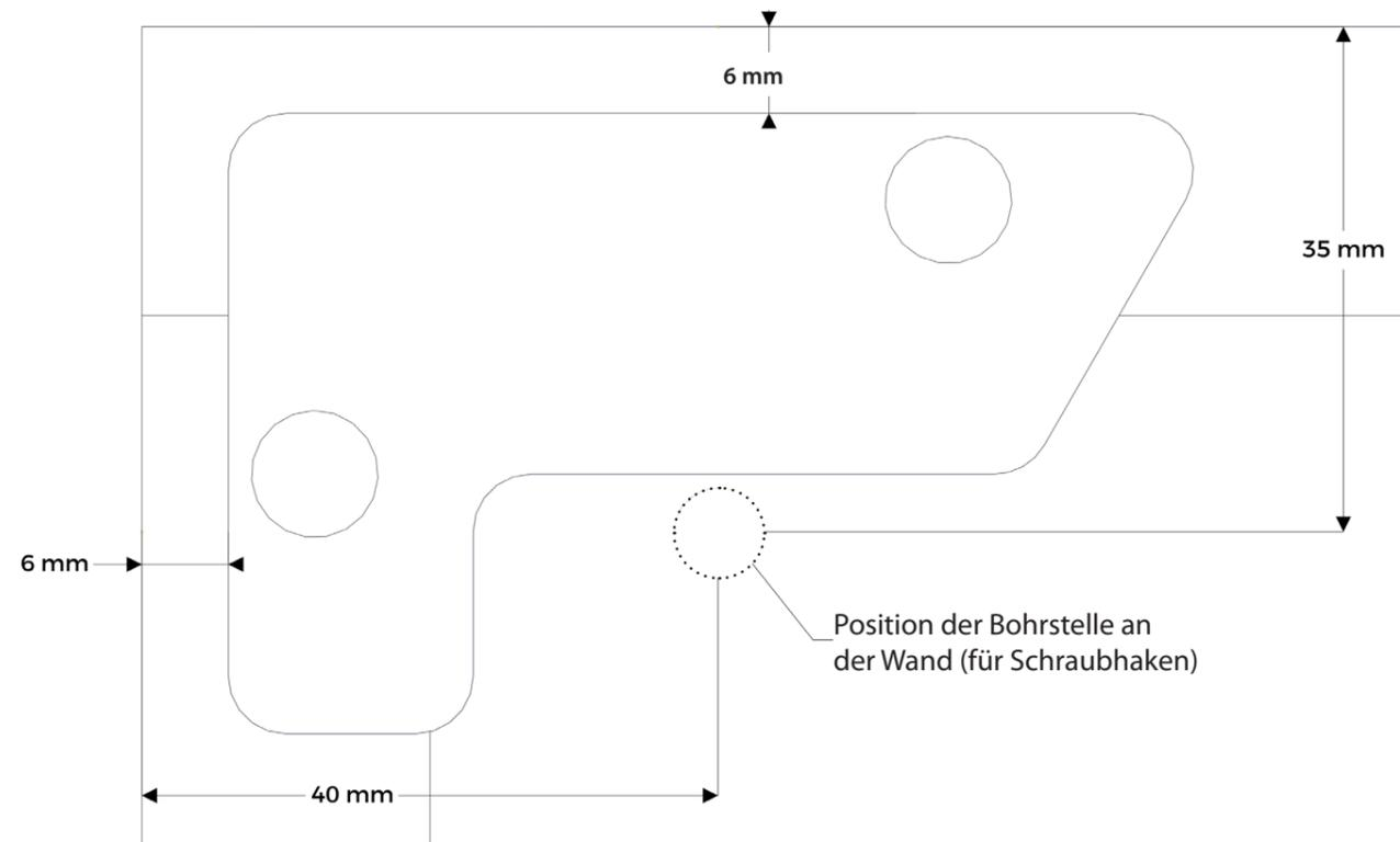
**3.** Die Bohrstellen für die Schraubhaken an der Wand markieren und Löcher bohren. Position der Bohrstellen genau beachten – siehe Skizze. Kunststoffdübel in die Bohrlöcher stecken, Schraubhaken eindrehen.
