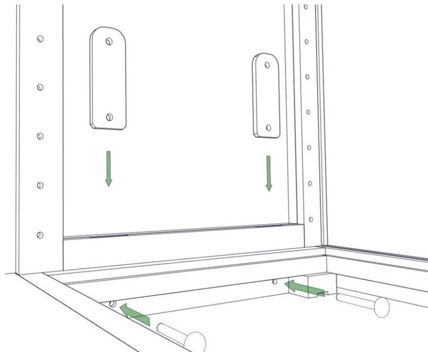
**11.** Spanschlosszapfen in die Laschen stecken und mit Spannkeilen fixieren (mit dem Hammer gefühlvoll festklopfen).
