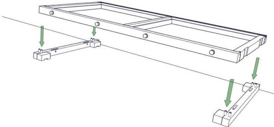
2. Untere Einhängeleiste auf die Gratdübel des Bodenrahmens stecken.
