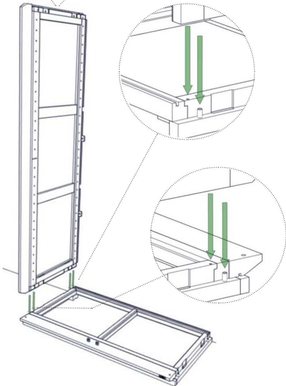
**10.** Lange Laschen durch die Schlitzte der Seitenteile schieben, unten mit den Pilzdübeln fixieren.
