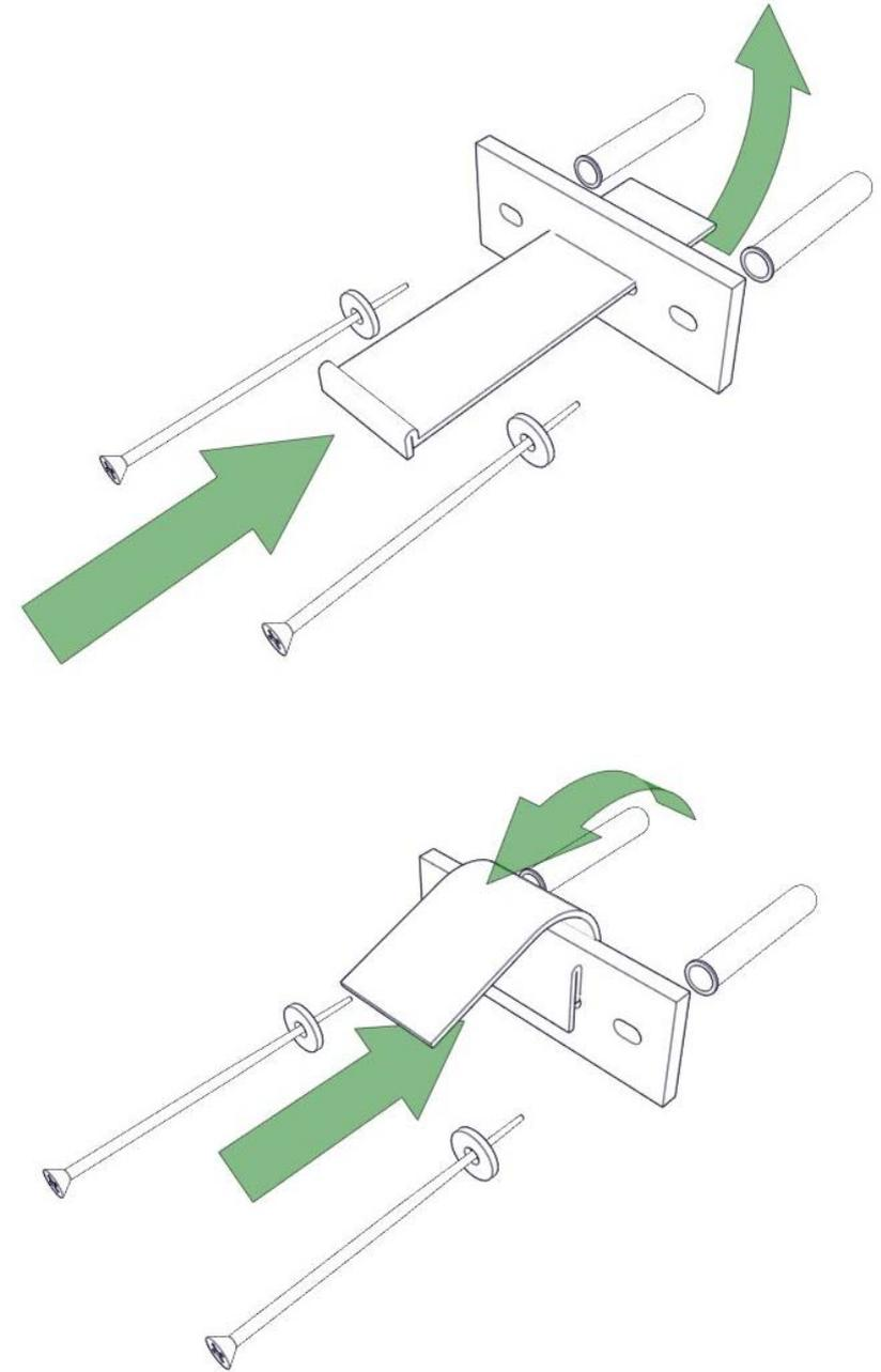
7. Die Kippsicherungen – mit bereits eingefädeltm Gurt! – mittels Schrauben (4,5 x 50 mm) und Beilagscheiben an der Wand montieren.
