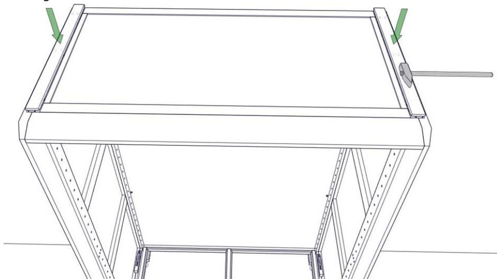
**19.** Falls notwendig: Schrank mit Hilfe der Sockelkeile waagrecht ausrichten.
