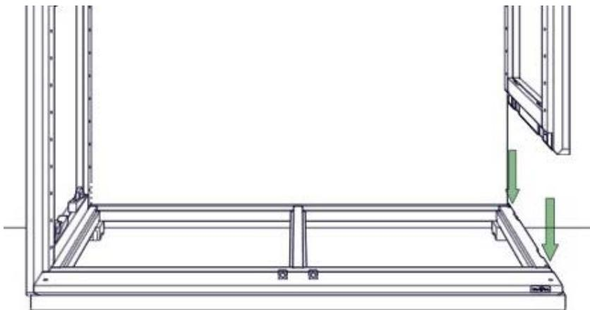
**15.** Zur Verbindung des rechten Seitenteils mit der Rückwand: Wiederholung des Montageschrittes 13.
