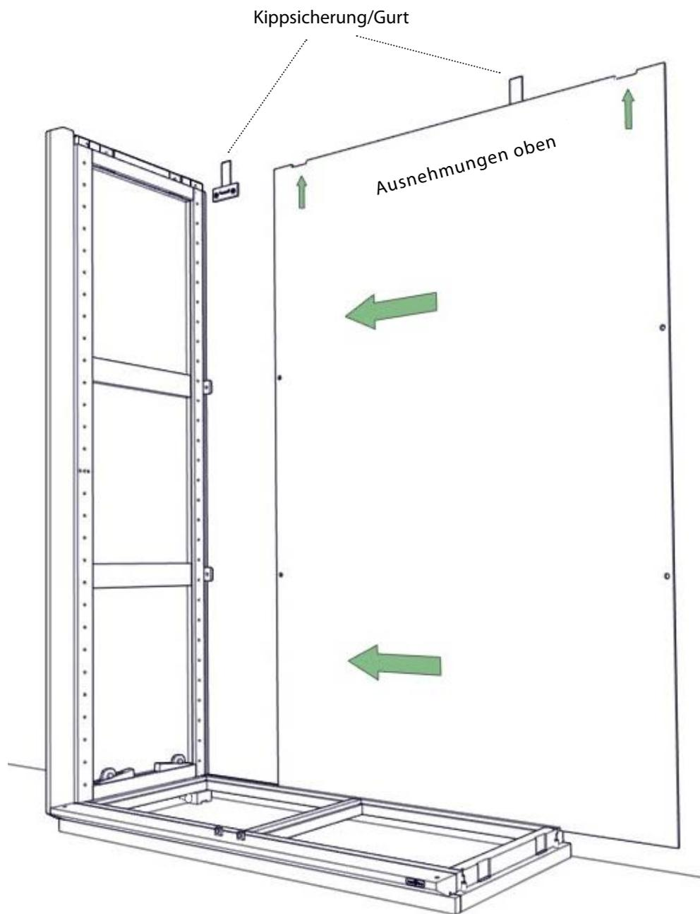
**13.** Rückwand mit kurzen Dübeln am Seitenteil des Schrankes fixieren. Dübel mit dem Hammer gefühlvoll festklopfen. Gurte der Kippsicherung müssen an der Innenseite der Rückwand herunterhängen.
