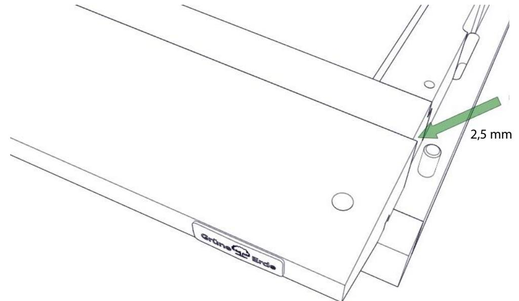
5. Position des Bodenrahmens auf dem Fußboden prüfen: Er muss exakt dort liegen, wo der Schrank stehen soll. Dann Bohrlöcher für die Kippsicherung an der Wand markieren. Dazu Bohrschablone mit Hilfe der Wasserwaage exakt an der Wand positionieren (siehe Skizze). Bohrer und Dübel dem Baustoff der Wand entsprechend wählen (Ziegel, Holz, Gipskarton, Beton ...), Löcher bohren, Dübel einstecken.
