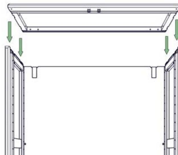
**18.** Verbindungsplatten aufstecken und mit dem Hammer gefühlvoll festklopfen – Schlagholz dazwischen!
