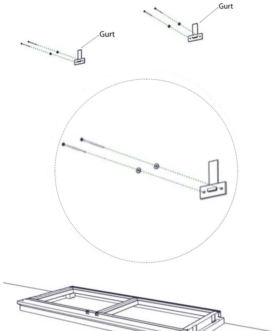
8. Rückwand-Fixierungsplättchen an den Seitenteilen mit je 2 langen Dübeln montieren. Dübel bündig hineinklopfen.
