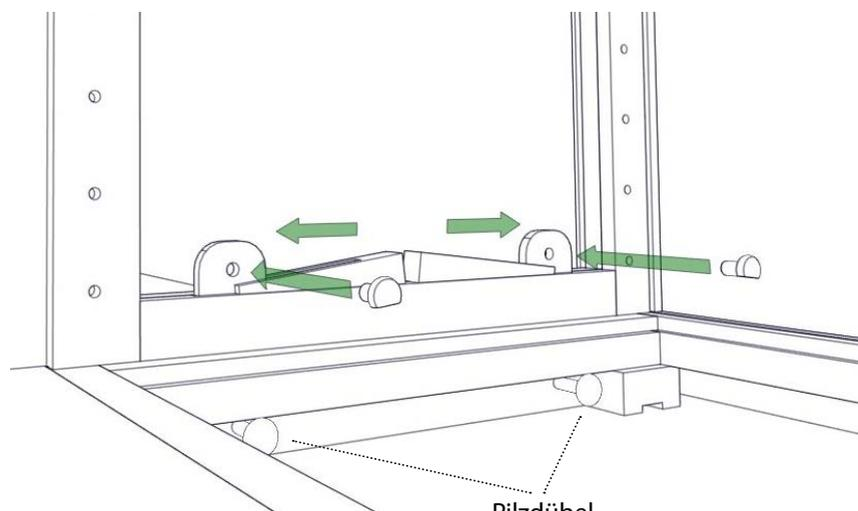
**12.** Rückwand in die Nuten des Bodenrahms und des Seitenteils einsetzen.
