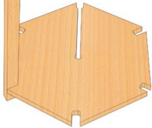
**3.** Zweiten Spant auf eine der weniger tiefen Ausnehmungen der 6-Eck-Platte sowie auf den 6-Eck-Ring stecken.
