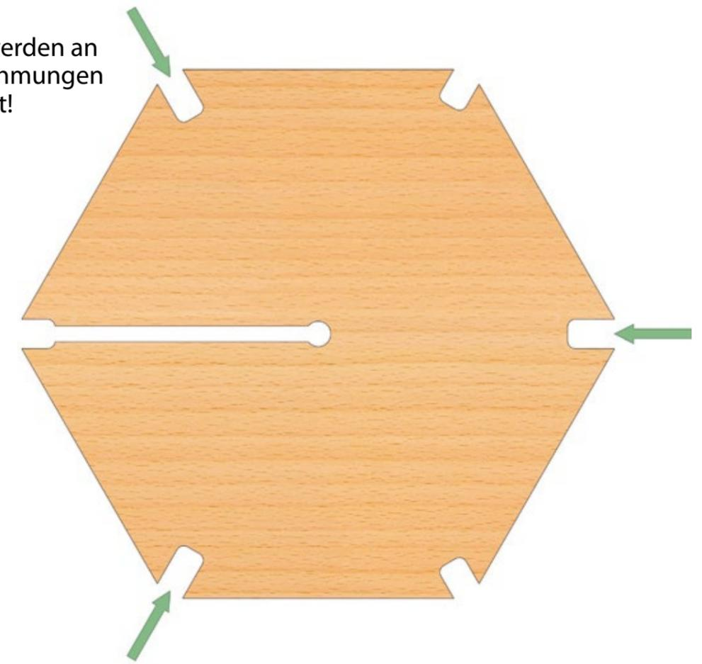
**1.** Den ersten Spant kantenbündig auf eine der weniger tiefen Ausnehmungen der 6-Eck-Platte stecken. Dabei auf die richtige Positionierung der Bauteile zueinander achten.
