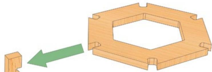
**2.** Den 6-Eck-Ring kantenbündig auf den Spant stecken.
