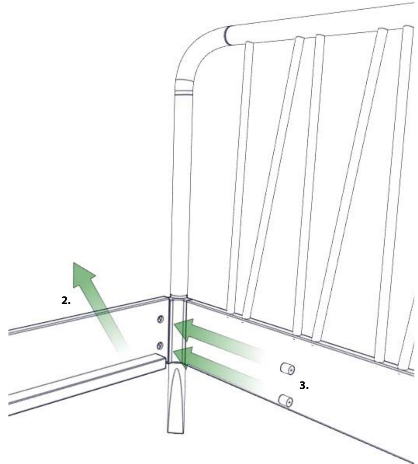
**4.** Seitenwangen an den Enden kräftig nach unten drücken. Dadurch werden die Bauteile fest zusammengefügt.
