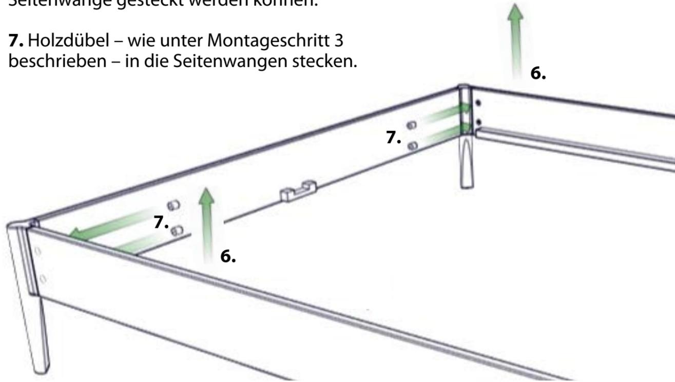
**8.** Seitenwangen an den Fußenden kräftig nach unten drücken. Dadurch werden sie mit dem Fußteil fest zusammengefügt.
