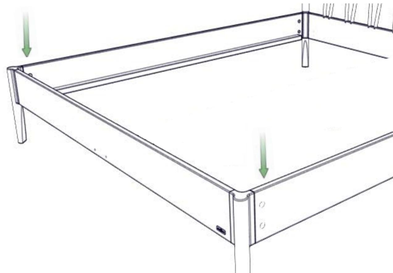
**9.** Mittelfüße aufstellen, Mittelsteg in den Bettrahmen einlegen und mit den Mittelfüßen verbinden (Dübel in die Bohrungen).
