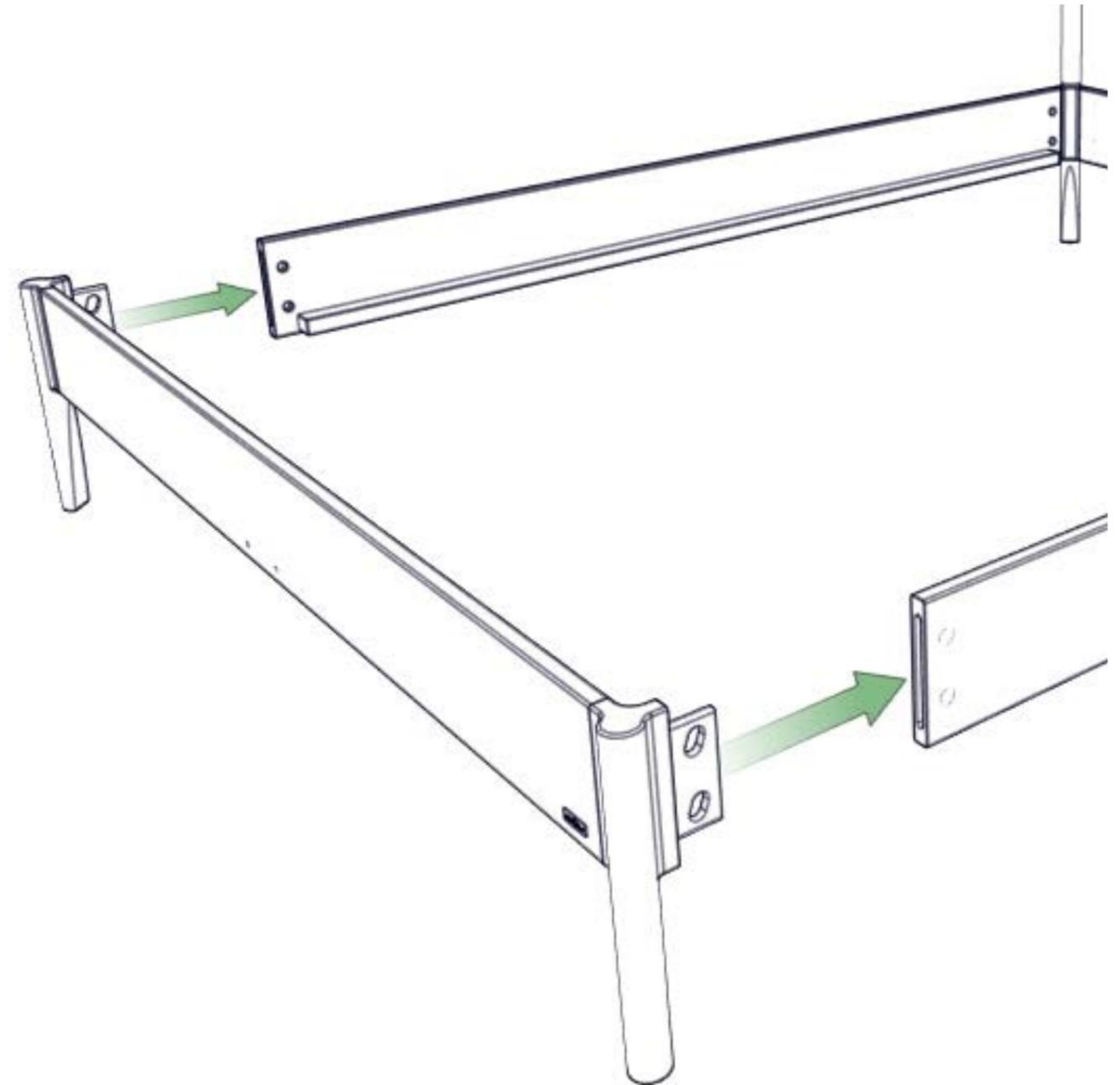
**6.** Seitenwange etwas anheben, damit die Holzdübel leichter in die Bohrungen der Seitenwange gesteckt werden können.
