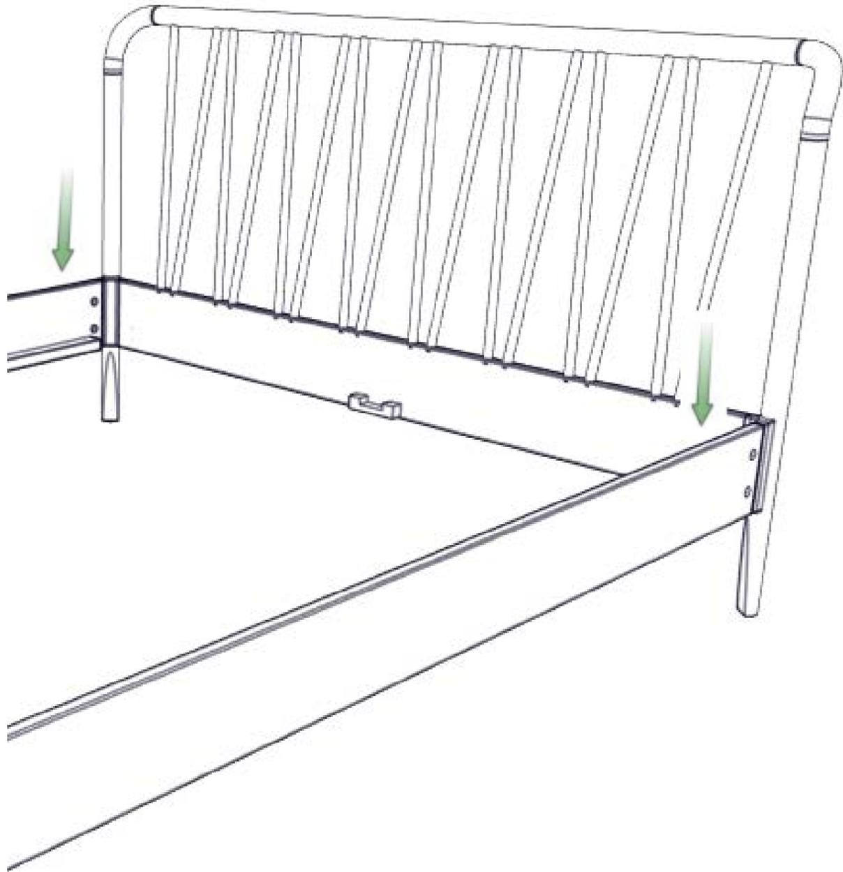
**5.** Holzlaschen des Fußteils in die Schlitze der Seitenwangen stecken.
