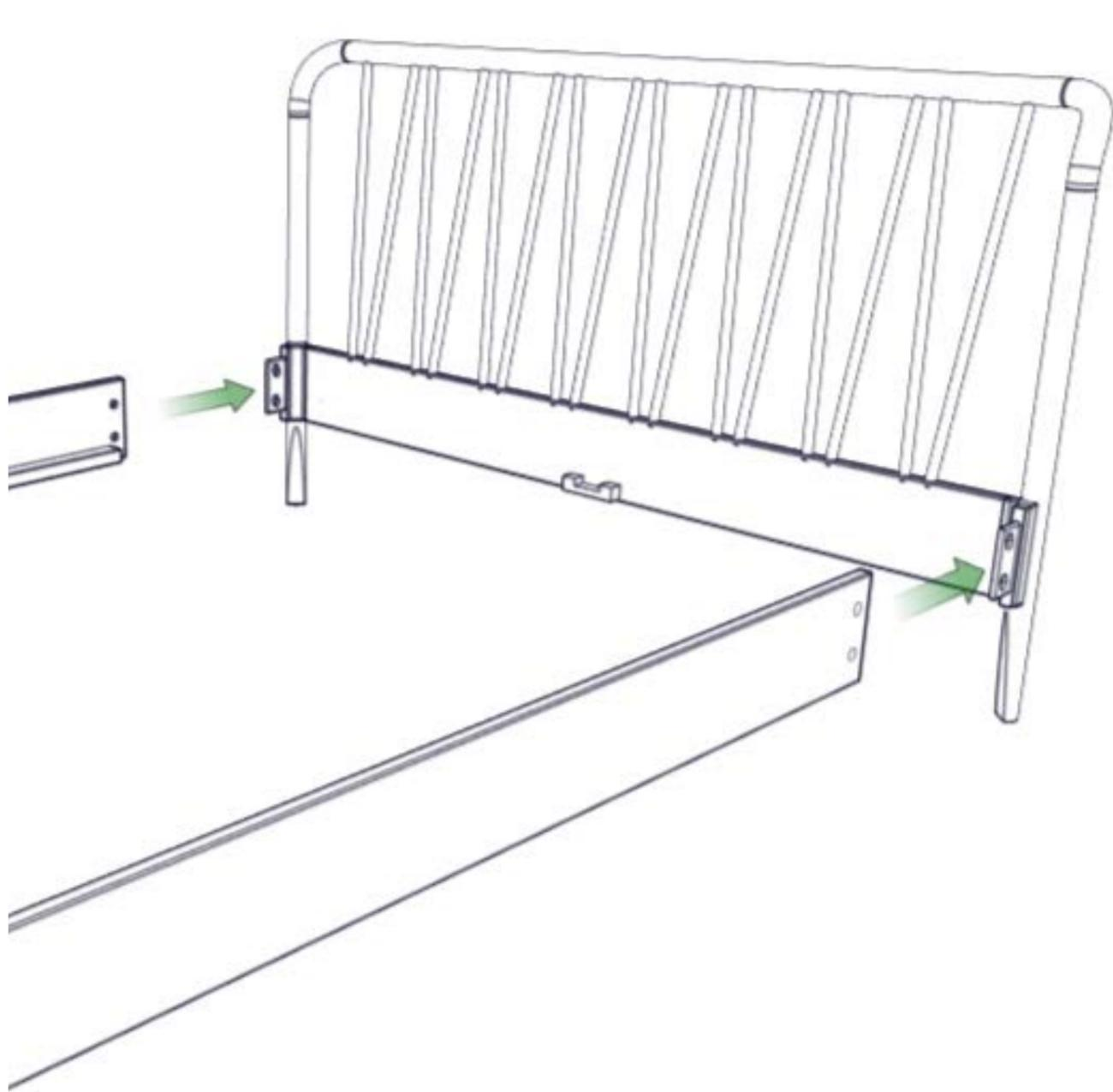
**2.** Seitenwange etwas anheben, damit die Holzdübel leichter in die Bohrung der Seitenwange gesteckt werden können.
